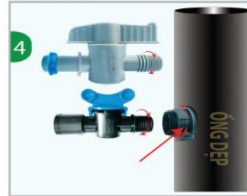
Vặn phụ kiện 21 tùy ý vào CỤC KHỞI THỦY, giữ ĐAI ỐC và siết ngược chiều nhau cùng lúc 2 phụ kiện để kết nối chắc chắn hơn
